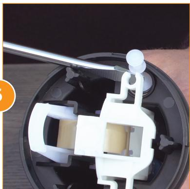
Para remover el motor y el soporte de la válvula de la cobertura del pistón, va a necesitar un destornillador de cabeza plana. Utilice el destornillador para remover las válvulas superiores. Las válvulas parecen puntillas de golf y saldrán fácilmente de la cobertura del pistón. Colóquelas a un lado.
