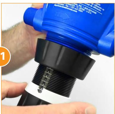
Si la escala de su preferencia no se muestra hacia afuera, afloje y remueva la tuerca del vástago de inyección.
