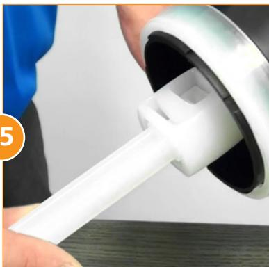
Reinstale el émbolo por la parte inferior de la cobertura del pistón, y dele un cuarto de vuelta en la dirección de las manecillas del reloj para encajararlo.
