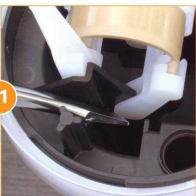
La clave es asegurarse que la barra de conexión blanca se sienta en las muescas dentro de la cobertura del pistón.
