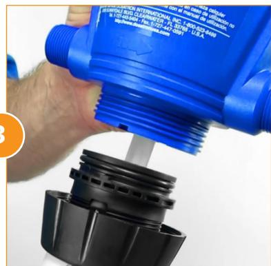
Jale el vástago hasta removerlo de la unidad. Coloque el cuerpo de la unidad a un lado.
