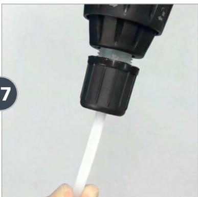
Despues de apretar la tuerca, jale la manquera para asegurarse que esta conectada correctamente.
