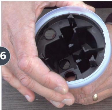
Alinee el diente en el anillo con el agujero en la cobertura del pistón. Presione hacia abajo, y dele un cuarto de vuelta en la dirección de las manecillas del reloj. Si se dificulta darle la vuelta al anillo o este se levanta fácilmente, sáquelo, y realinéelo.
