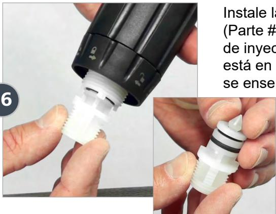
Instale la nueva **Válvula Cheque** (Parte #: **PJDI234**) en el vástago de inyección. Asegurese que está en la misma posición que se enseña en la imagen.
