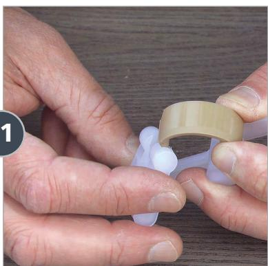
Deslice la otra punta del resorte polímero Omega dentro de la **Barra de Conexión** (**Parte #:** PDI649). La clave para este paso es asegurarse que la parte superior curvada de la barra de presión, está en la misma dirección del resorte polímero Omega.
