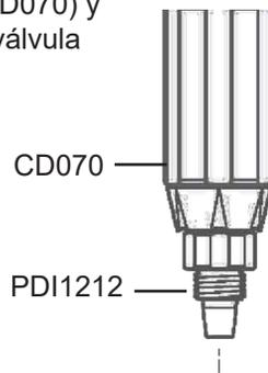
5. Remueva y reemplace el sello (J051), el resorte (M072) y el cono (P170) de la válvula cheque y reemplace con las partes nuevas. Asegúrese de que la ranura del sello esté arriba apuntando hacia el cono.
