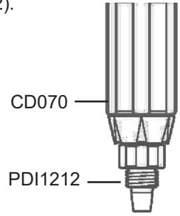
7. Aplique **Dosa-Lube** sobre el o-ring (J024) de la manga de inyección, y sujete el montaje de inyección (CD070) en la unidad.
