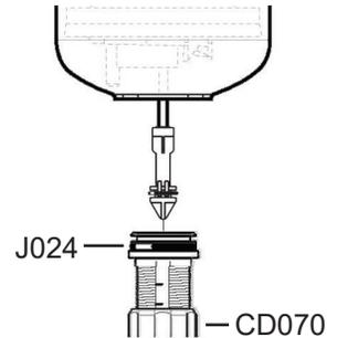
8. Fije el montaje de inyección (CD070) atornillando los 4 tornillos (M337) al plato metálico (M079).
