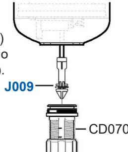
4. Desatornille la lengüeta de la válvula cheque (PDI1212) del montaje de inyección (CD070) y remueva la válvula cheque.
