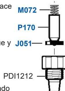
6. Inserte la válvula cheque de nuevo en el montaje de inyección (CD070) y atornille la lengüeta (PDI1212).
