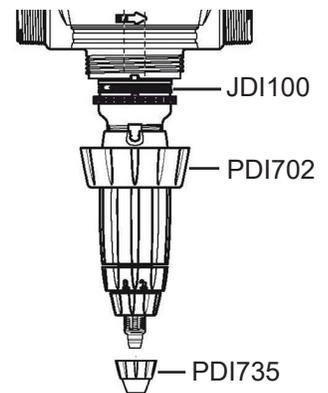
Corte 1 pulgada en línea recta, de la punta de la manguera de succión. Sujete la manguera a la lengüeta y atornille la tuerca de la manguera de succión (PDI735).
