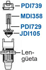
Coloque la nueva guía superior (PDI739) sobre el cono, mientras empuja y gira 1/4 de vuelta en dirección de las agujas del reloj para asegurarla.
