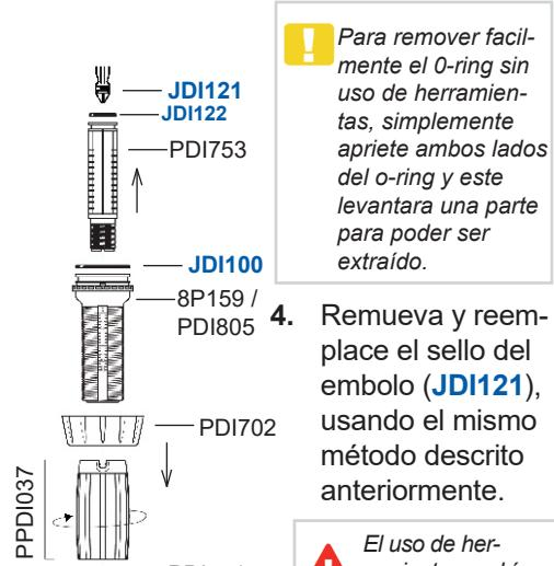
**!** Para remover fácilmente el o-ring sin uso de herramientas, simplemente apriete ambos lados del o-ring y este levantara una parte para poder ser extraído.
