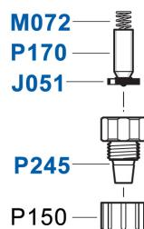
9. Coloque el sello nuevo (J051) en la lengüeta nueva (P245) de la válvula cheque, introduzca el cono (P170) y el resorte (M072). Coloque la lengüeta de la válvula cheque (P245) en posición y atornille la tuerca de la manguera de succión (P150).
